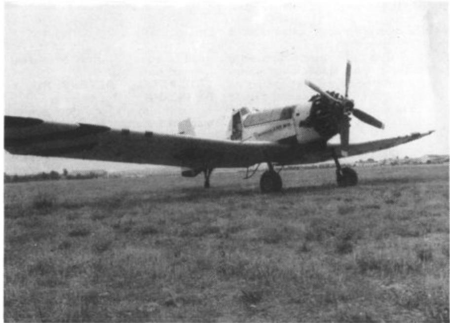
Avión DROMADER, carga en tierra. Capacidad 2.500 litros de agua con retardante.
